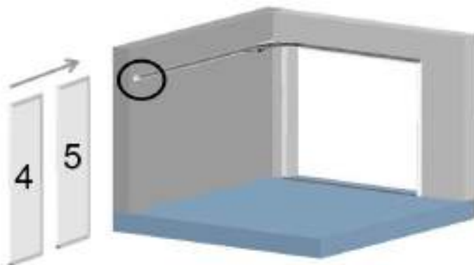
Insertion des chariots de guidage dans le rail
